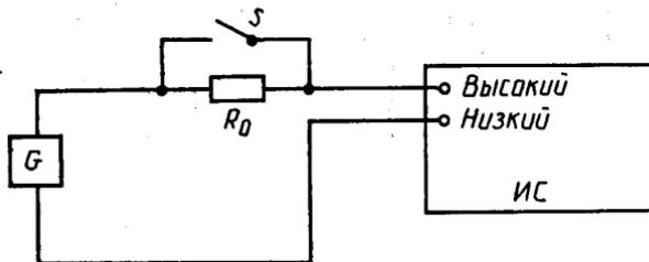
*G*—источник переменного напряжения (переменная частота, постоянная амплитуда); ИС—испытуемый ЦИП; *S*—переключатель; *R<sub>0</sub>*—резистор, сопротивление которого должно быть приблизительно равно 10% значения входного сопротивления ИС; Высокий — импедансы.
