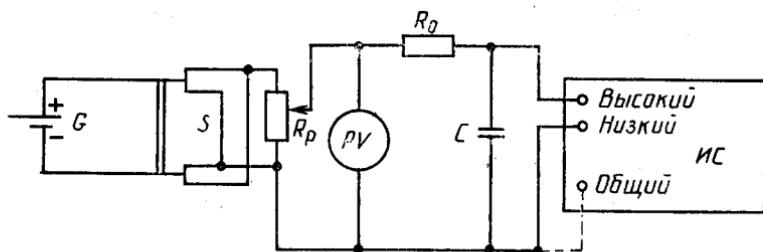
*G*—батарея; *PV*—вольтметр;  $R_0$ —резистор, сопротивление которого выбирают от 1 до 100 МОм в зависимости от тока смещения;  $R_p$ —потенциометр, сопротивление которого приблизительно равно 1/100 от  $R_0$ ; *C*—кondенсатор 1 мкФ; *S*—двуходольный переключатель;
