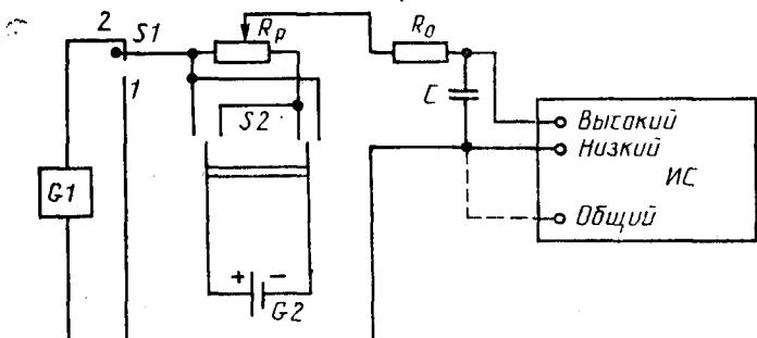
*G1*—источник постоянного напряжения; ИС—испытуемое СИ; *S<sub>1</sub>*, *S<sub>2</sub>*—переключатели; *G<sub>2</sub>*—батарея; *R<sub>0</sub>*—резистор, сопротивление которого должно составлять от 10 до 50% значения входного сопротивления испытуемого СИ; *R<sub>p</sub>*—потенциометр, сопротивление которого должно быть приблизительно 1/100 от *R<sub>0</sub>*; *C*—конденсатор, 0,1 мкФ; Высокий, Низкий — импедансы.
