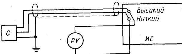
*G*—источник переменного тока; ИС—испытуемый ЦИП; *PV*—вольтметр переменного тока с входным сопротивлением  $> 1 \text{ МОм}$ ;
