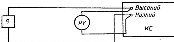
*G*—источник постоянного тока; ИС—испытуемое СИ; *PV*—вольтметр постоянного тока с входным сопротивлением  $> 1$  МОм;
