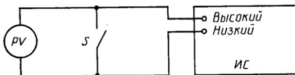
$PV$ —вольтметр постоянного тока с входным сопротивлением не менее чем в 50 раз больше конечного значения наибольшего диапазона измерений (для уменьшения ошибки, обусловленной нагрузкой);  $S$ —выключатель; ИС—испытуемый ЦИП;
